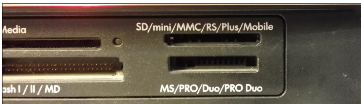
Photo 1 – Lecteur de carte SD d'un ordinateur : fente située sous les inscriptions « SD/mini/MMC/RS/Plus/Mobile »
